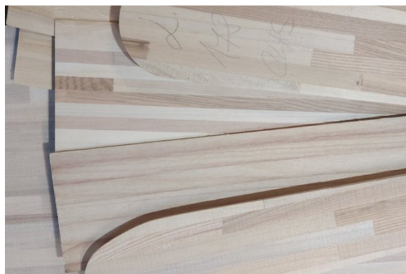
V jadrách sa na dosiahnutie optimálnych výsledkov kombinujú tri druhy drevín.
